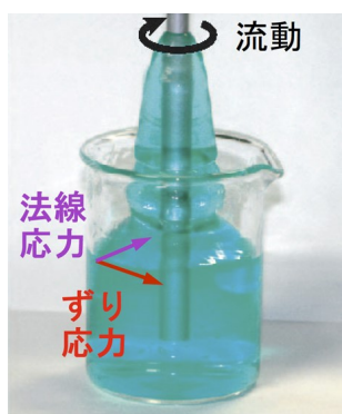
図1. 高分子液体(この例ではスライム)に金属シャフトを差し込み、これを回転させて高分子が緩和できないほどの高速流動を行うと、流動方向のずり応力のみならず、流動と直角方向の法線応力も発生し、後者のために液体の真ん中が盛り上がります。この現象は、高分子鎖が流動方向に配向され、鎖の熱的張力が積算されて巨視的な法線応力となるために起こる現象で、Weissenberg 効果と呼ばれています。
